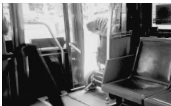
地下鉄メトロセンター駅の自動券売機。点字、凸文字、拡大文字で、切符の買い方がわかりやすく表示されている(上)。市内には、リフト付きのノンステップ車両のバスが走り、車内には跳ね上げ式の車いすスペースが設けられている(下)。
